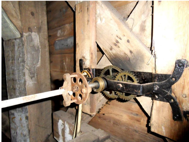
Afb.3 Wijzerwerk onbeschermd tegen vuil
